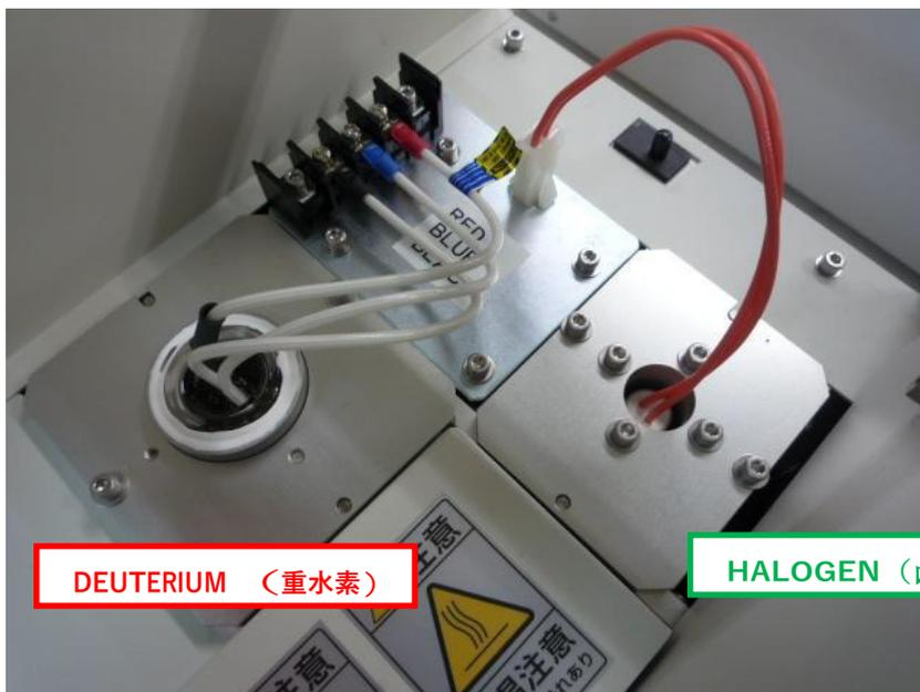
更換燈泡的時候，為了避免燈泡被指紋等污染的情況，請佩戴手套進行更換作業。
