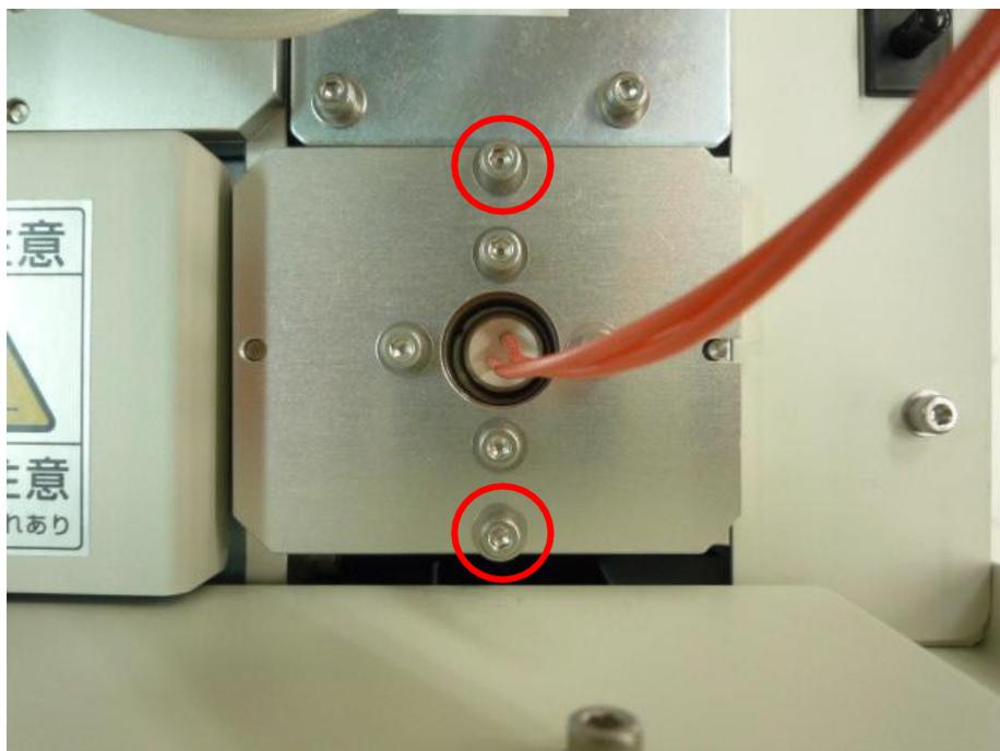
11. 取下後，如下圖所示，拆下燈泡的固定螺絲。
